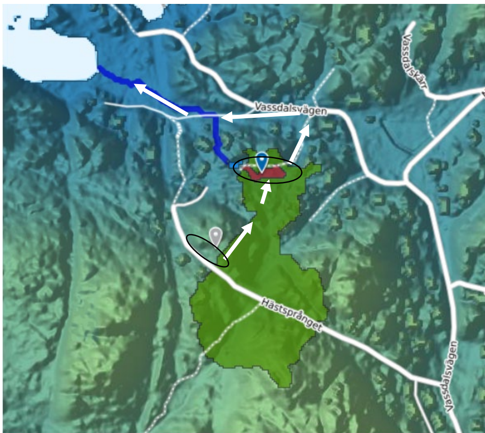
Figur 3 Ungefärligt avrinningsområde. Pilar visar riktning på ytavrinningen. Bild från Scalgo
