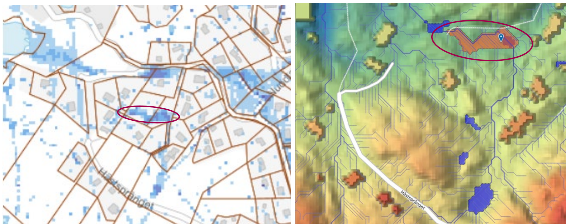
Figur 5 Befintlig skyfallssituation i figuren till vänster. Resultat från Scalgo till höger. Inringat område visar lågpunkten där vatten ansamlas på Brännö 5:71 och 5:44.
